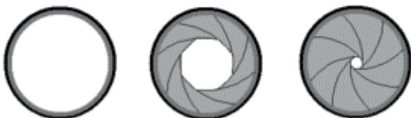
Fig. 1.3 Rappresentazione di un diaframma: tutto aperto | a metà apertura | chiuso
