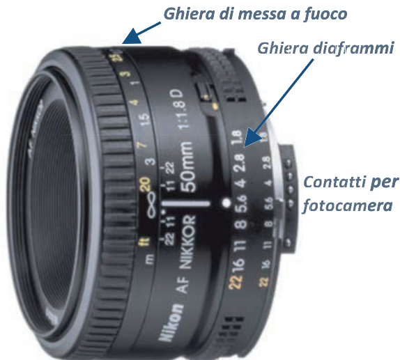
Fig. 1.4 Obiettivo Nikon di focale fissa 50mm Max apertura f/1.8 | Min apertura f/22
